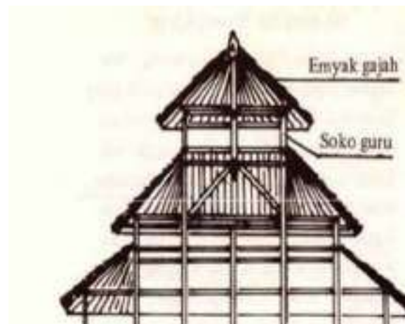
Gambar 16. Hirarki struktur atap bangunan joglo
