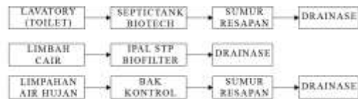
Gambar 29. Diagram Instalasi Air Kotor & Bekas
