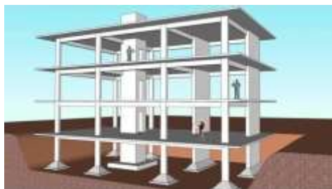
Gambar 17. Struktur kolom balok, dan dinding geser
