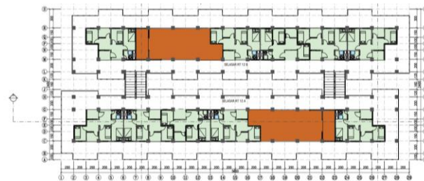
Gambar 11. Denah bangunan Lt.3 & Lt.6
