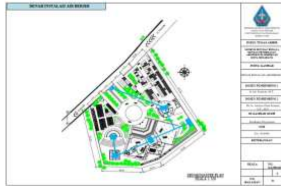
Gambar 27. Denah Utilitas Air Bersih
